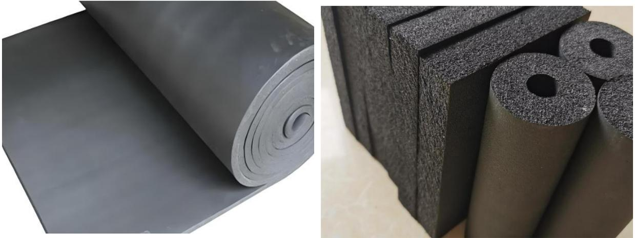
橡塑保温材料是以橡胶和聚氯乙烯 (PVC) 为主要原料，经发泡工艺制成的柔性闭孔泡沫材料，其表面光滑、不吸水，无需额外防潮层。橡塑保温材料通过在生产过程中添加一定的阻燃剂到原料中，能够在材料燃烧时分解出不易燃烧的物质，覆盖在材料表面，隔绝氧气，通常燃烧性能等级可达到B1级。
