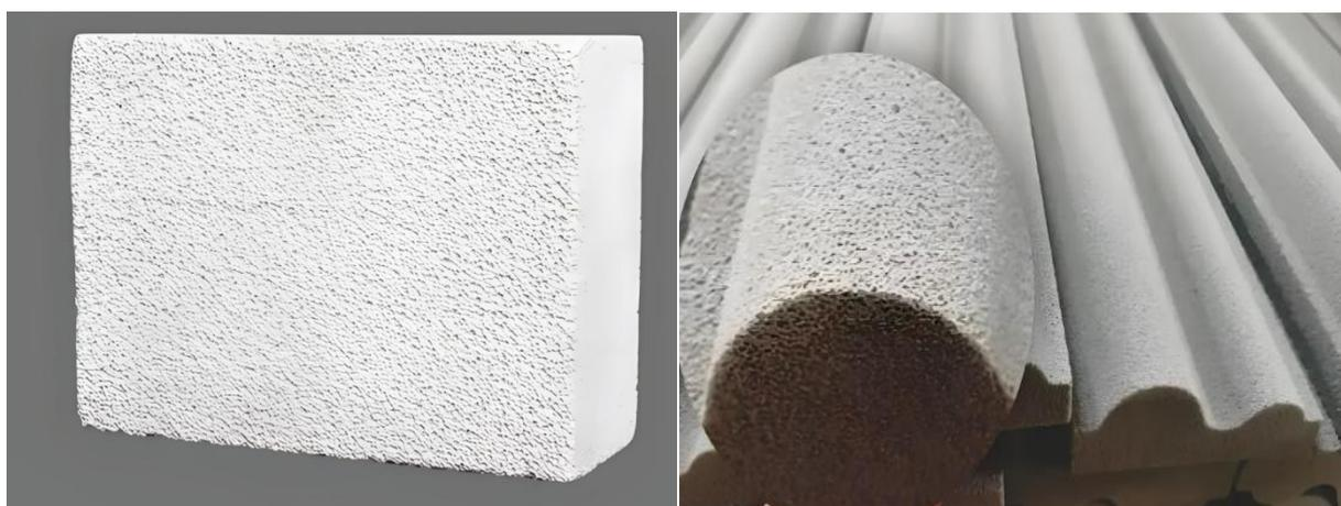
发泡陶瓷是一种以陶瓷原料（如黏土、尾矿等）经高温烧结形成的多孔轻质无机保温材料，具有不燃、耐高温、抗腐蚀、耐久性强等特点，但脆性较大、成本较高且可加工性较弱。
