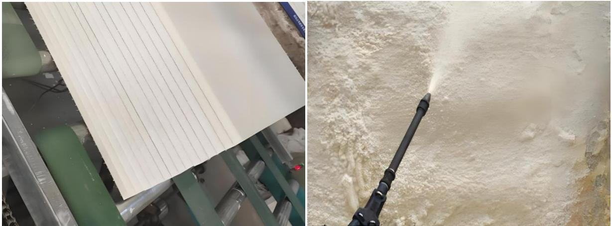
聚氨酯，全名为聚氨基甲酸酯，是由多元醇和多异氰酸酯经缩聚反应形成且力学性能优异的高分子材料，可塑性极强。聚氨酯泡沫有软泡和硬泡两种，软泡为开孔结构，硬泡为闭孔结构。聚氨酯软泡相对柔软，具有良好的弹性和回弹性，常用于家具、床垫等产品的生产。
