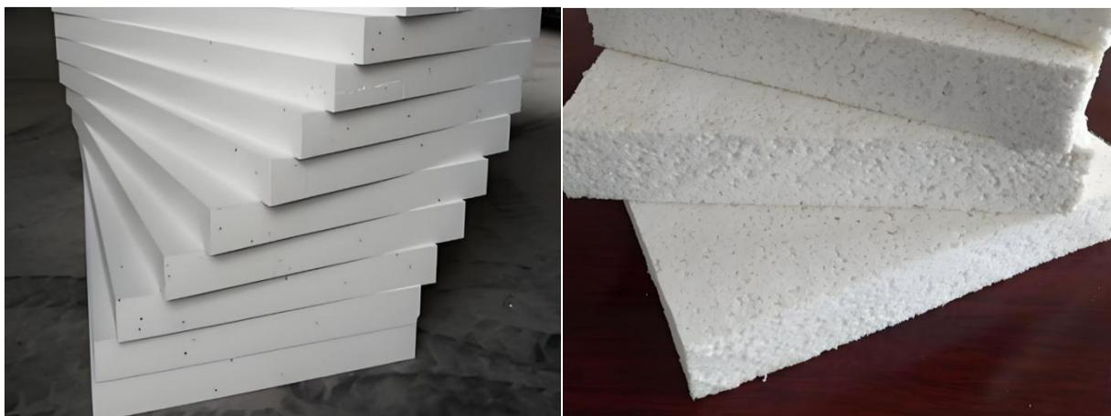
简称模塑聚苯板（EPS），是以可发性聚苯乙烯颗粒经加热预发泡、模压成型制成的闭孔结构泡沫塑料板材，具有质轻、导热系数低、成本低、易加工等特点，但燃烧性能相比无机材料较差，为B2级，部分EPS板通过添加阻燃剂达才可达到B1级。
