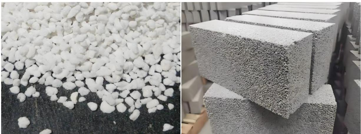
珍珠岩是一种轻质多孔的无机保温材料，由天然珍珠岩矿石经高温煅烧膨胀而成，具有密度低、导热系数小、燃烧性能为A级、吸音、耐腐蚀等特点。
