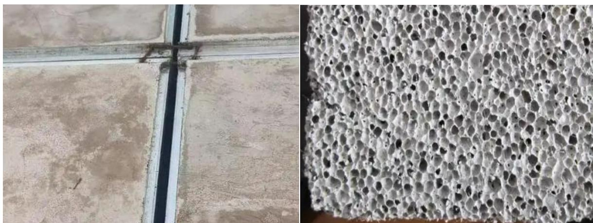
发泡水泥是指通过物理或化学方法在水泥浆中引入气体，形成大量封闭气孔，从而制成轻质保温材料，燃烧性能为A级。
