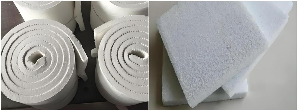
硅酸铝棉保温材料是以硅酸铝纤维为主要成分的无机耐火保温材料，具有耐高温（最高可达1600℃）、导热系数低、化学稳定性好、抗热震性强等特点，燃烧性能为A级。
