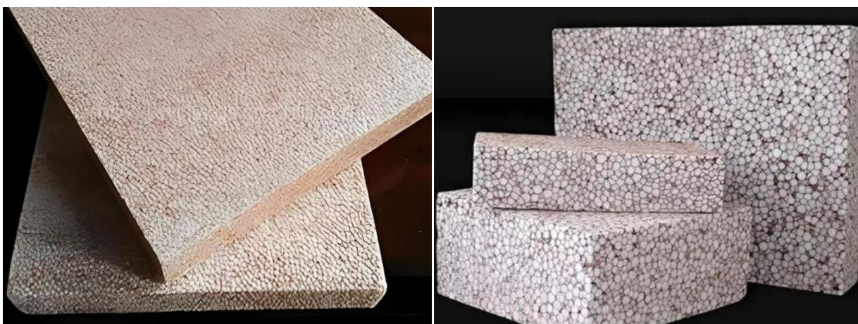
热固改性聚苯板是指采用颗粒防火隔离膜技术，将阻燃浆料裹覆EPS单体颗粒，形成防火隔离膜，使每个颗粒形成相对独立的有机颗粒防火单元，让聚苯乙烯从热塑性转为热固性（遇火不熔融、不收缩），燃烧性能可达到A级。
