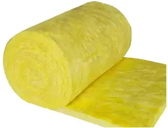
玻璃棉是一种无机纤维材料，主要成分为二氧化硅（ $\text{SiO}_2$ ）、氧化铝（ $\text{Al}_2\text{O}_3$ ）等玻璃氧化物，由熔融玻璃离心拉丝制成，燃烧性能为A级。
