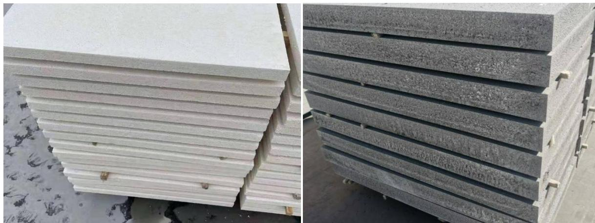
聚合聚苯板是指聚苯乙烯原料经预热发泡颗粒后，再与无机防火材料混合搅拌覆膜，加入泡沫板设备加热二次发泡成型，通过在聚苯板内部形成防火保护层，使其防火等级达到A2级。
