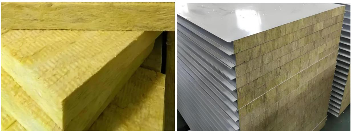
通过固化、切割制成的无机保温隔热材料，燃烧性能为A级。岩棉复合板，是指在岩棉板基础上复合其他材料（如水泥砂浆、镀锌钢板、铝箔等），形成多层结构，提升整体性能。例如，水泥复合岩棉板，彩钢岩棉复合板等。
