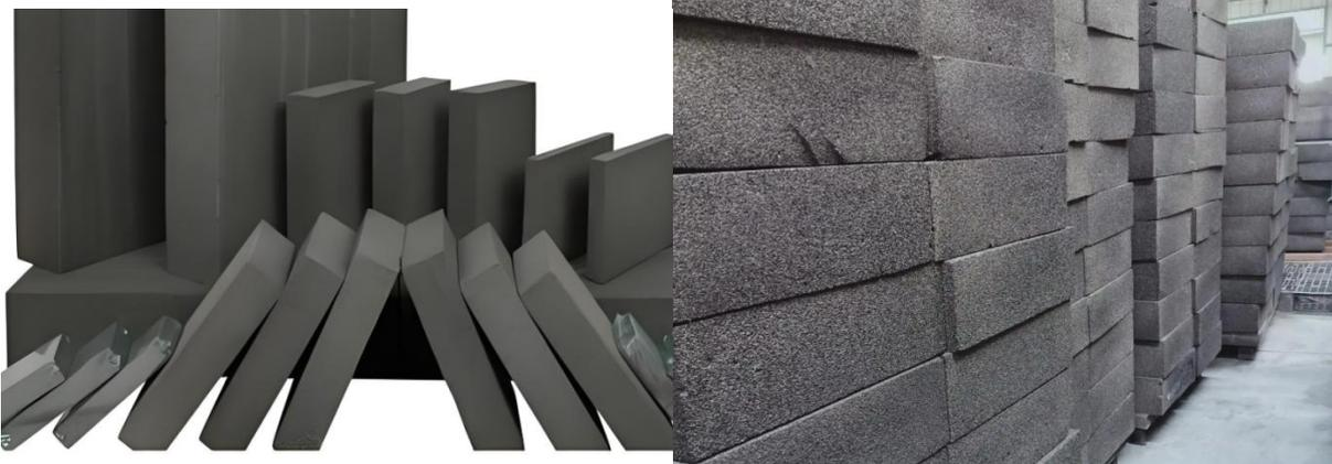
泡沫玻璃是由玻璃原料、发泡剂、改性添加剂等制成的无机非金属玻璃材料，燃烧性能为A级。它内部是发泡结构的硬质保温材料，含有大量直径为1~2毫米的均匀气泡结构。与玻璃棉不同，玻璃棉形成的是纤维结构的开孔材料，具有一定的柔韧
