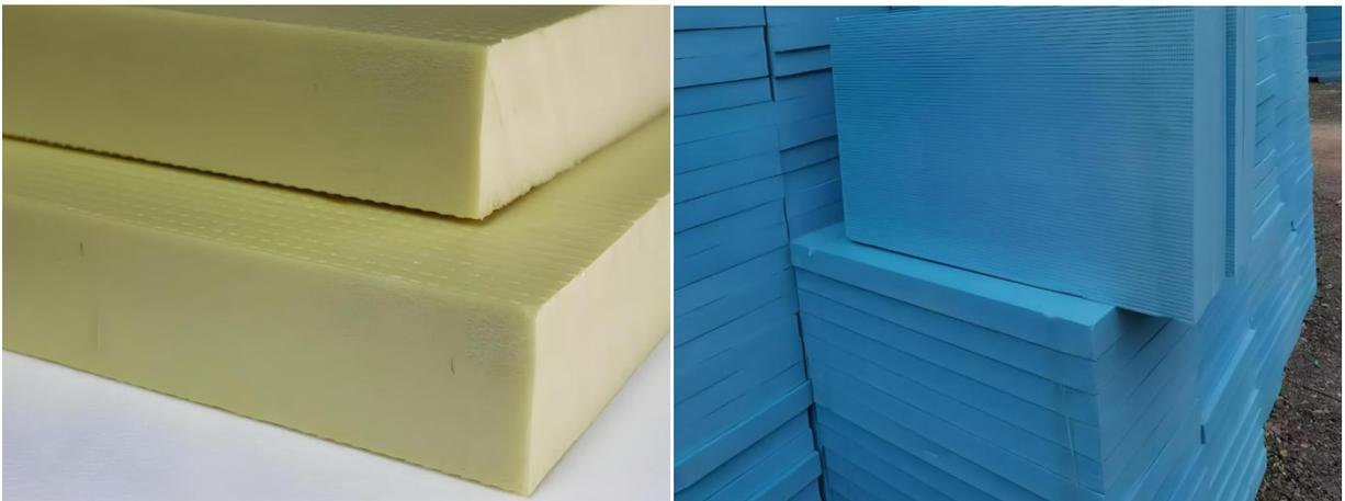
挤塑聚苯板（**XPS**），是指在聚苯乙烯树脂或共聚物中加入适量的添加剂后，通过挤塑工艺，在加热状态下经过模具挤出，形成具有细微闭孔结构的硬质泡沫板材，燃烧性能为**B2**级，具有闭孔率高、抗压性强、导热系数低、防潮耐腐蚀等特点，但与**EPS**类似，也需添加阻燃剂才可达到**B1**级燃烧性能。
